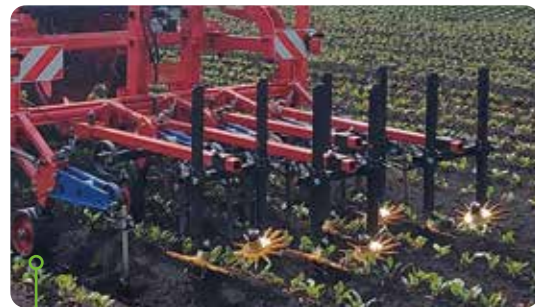
Sistema di sarchiatura parallelo a 4 file con fingerweeder 31 cm in barbabietola
