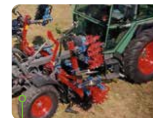
Sarchiatrice a stella, montata posteriormente, 2 file per coltivazione di patate
