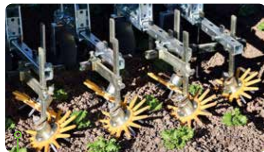
Il piccolo fingerweeder giallo con diametro di 24 cm, utilizzato nel robot Naio per la coltivazione della lattuga
