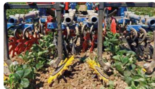
Sarchiatrice per fragole a 2 file, combinazione di coltivatore a stella e fingerweeder 37 cm, giallo
