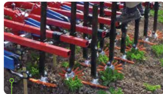
Sistema di sarchiatura a 8 file per lattuga con controllo manuale e fingerweeder 31 cm, arancione
