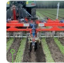
Bei größeren Arbeitsbreiten ist der wartungsarme Kettenantrieb doppelseitig angebaut.
