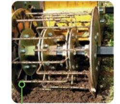
Verschiebbare Verstellelemente ermöglichen eine schnelle und optimale Anpassung an unterschiedliche Reihenabstände und Reihenweiten bei einfachster Handhabung.
