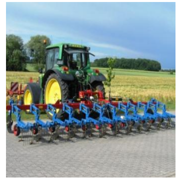
HABIHT Kohlhacke 11- rhg, Heckanbau mit Kamerasteuerung parallelogrammgeführt 2-18 Reihen, Abstand 45-120 cm Front, Heck, Zwischenachsenbau
