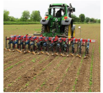
HABIHT- Heckanbau in Soja mit Kamerageführtem Verschieberahmen 12 Reihen
