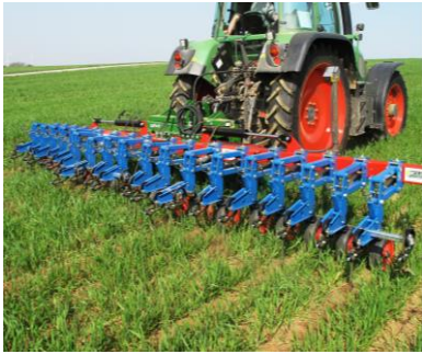
HABIHT Heckanbau mit kamerageführtem Verschieberahmen in Getreide
