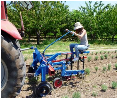
HABIHT Heckanbau mit Steuerung 1-rhg in Lavendel
