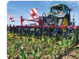
12-reihiges Hacksystem für Mais, mit Seitenverschieberahmen und Fingerhacke 37 cm, gelb.
