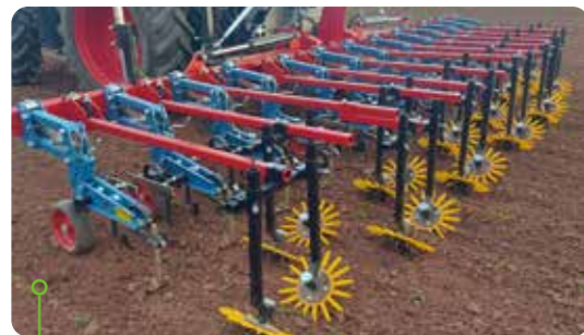
12-reihiges Hacksystem für Mais, mit Seitenverschieberahmen und Fingerhacke 37 cm, gelb.
