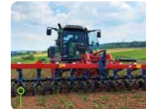
Habicht Frontanbau 12-reihig 6m in Zuckerrüben mit Tandem-parallelogramm.
