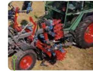
Sternhacke 4-rhg im Fendt GT 275 für Erdbeeraanbau. Gefederte Werkzeugträger mit Rankenschneidscheiben, 10 Sterne pro Reihe.
