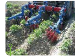
Sternhacke, Heck 2-rhg für Kartoffelbau. Parallelogrammgeführte Werkzeuge mit Vorlockerer, Dammstriegel, mechanische Selbststeuerung. 4 Sterne pro Reihe.
