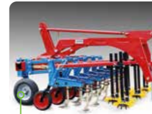
Habicht Frontanbau, 5-reihig mit Fingerhacke.
