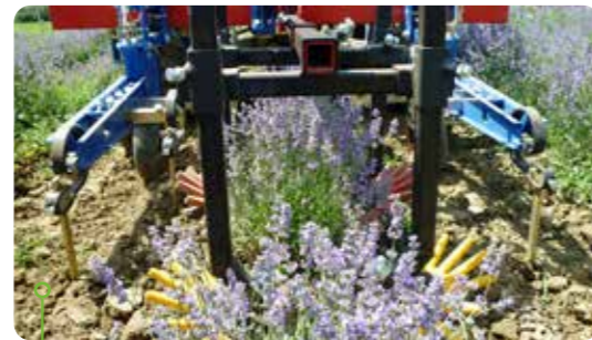
1-reihige Habicht Hacke in Lavendel mit doppelt angeordneter Fingerhacke.
