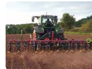
12-reihiges Hacksystem für Zuckerrüben, mit Seitenverschieberahmen und Fingerhacke 31 cm, gelb.
