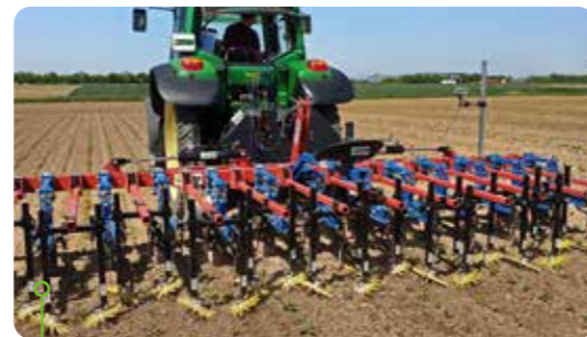
12-reihiges Hacksystem für Zuckerrüben, mit Seitenverschieberahmen und Fingerhacke 31 cm, gelb.
