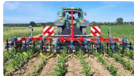
8-reihiges Hacksystem für Mais, mit Seitenverschieberahmen und Fingerhacke 37 cm, gelb.
