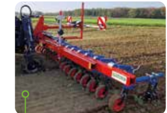
Habicht Hacksystem mit Seitenverschiebung 24-reihig für Zwiebeln.
